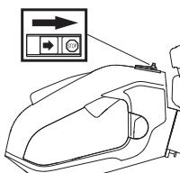
Запустите двигатель и проверьте, чтобы он остановился при переводе выключателя в положение стоп. Контакт остановки автоматически возвращается в положение запуска. Во избежание непроизвольного запуска, колпачок зажигания следует всегда снимать со свечи зажигания при монтаже, проверке и/или обслуживании.
