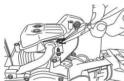
В некоторых глушителях предусмотрен специальный искрогаситель. Если ваш инструмент оборудован таким глушителем, искроулавливающую сетку следует периодически очищать. Для этой цели лучше всего использовать стальную щетку.
