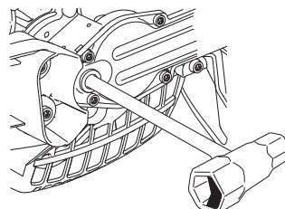
Смазка траверсов ножей производится специальной смазкой арт. номер 531 00 75-12 (УЛ 21) перед каждым использованием.
